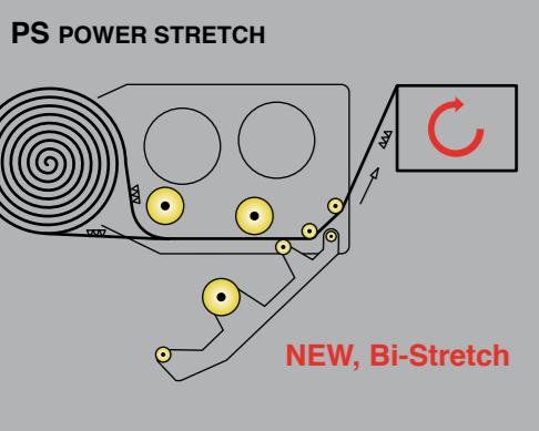
● Sistema di prestiro motorizzato a 3 rulli con 2 motori e variazione continua da 120 a 350% regolabile da quadro comandi.
