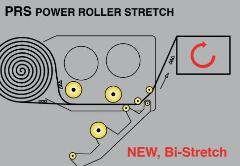
● Sistema di prestiro motorizzato a 3 rulli comandato elettronicamente con rapporti intercambiabili: 150 - 200 - 250%.
